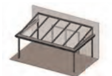
Pultdach mit Rinne beidseitig umlaufend
